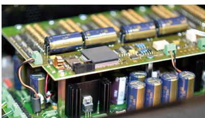
主线路板下方是电源处理，共有六组不同电压接头分别对数字与模拟供电，随处可见的金袍电容说明用料绝不手软
