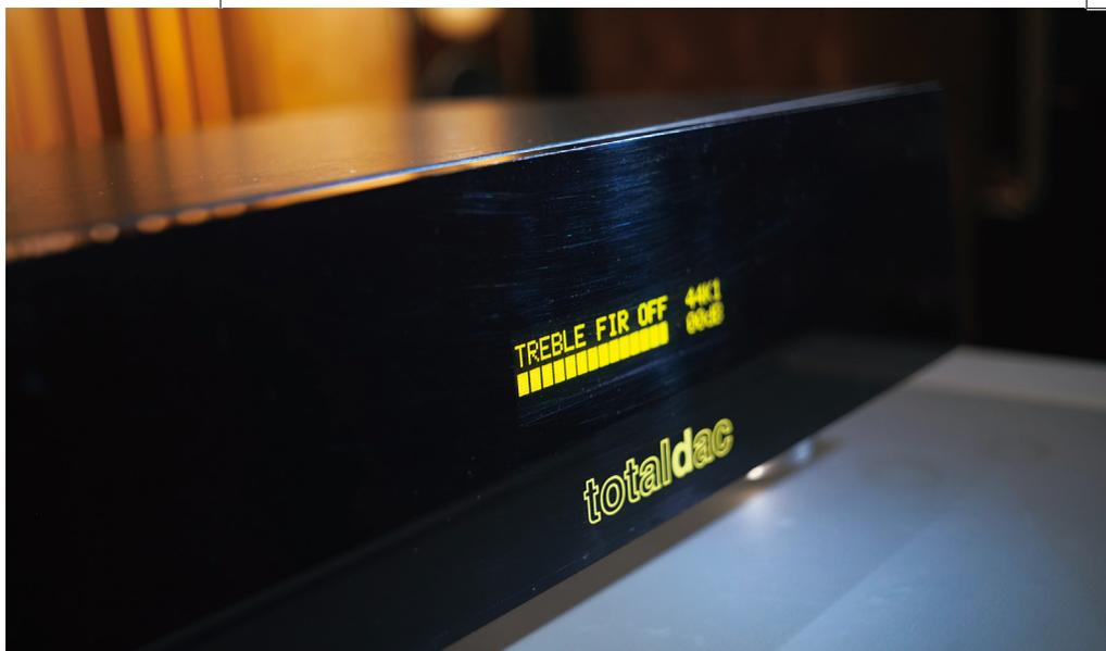
存，并以通信领域中常用的先入先出(FIFO)技术，储存约 10ms 的音乐讯号，使解码器内部时钟几乎不受到外部输入信号时钟的影响。
