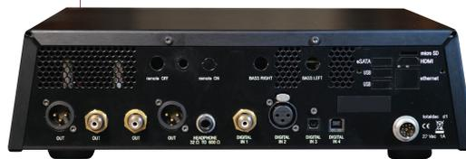
D1-Six 的输入接口齐备，数字输入有 USB、光纤、AES、同轴；模拟输出共有三组 XLR、RCA、耳机口
